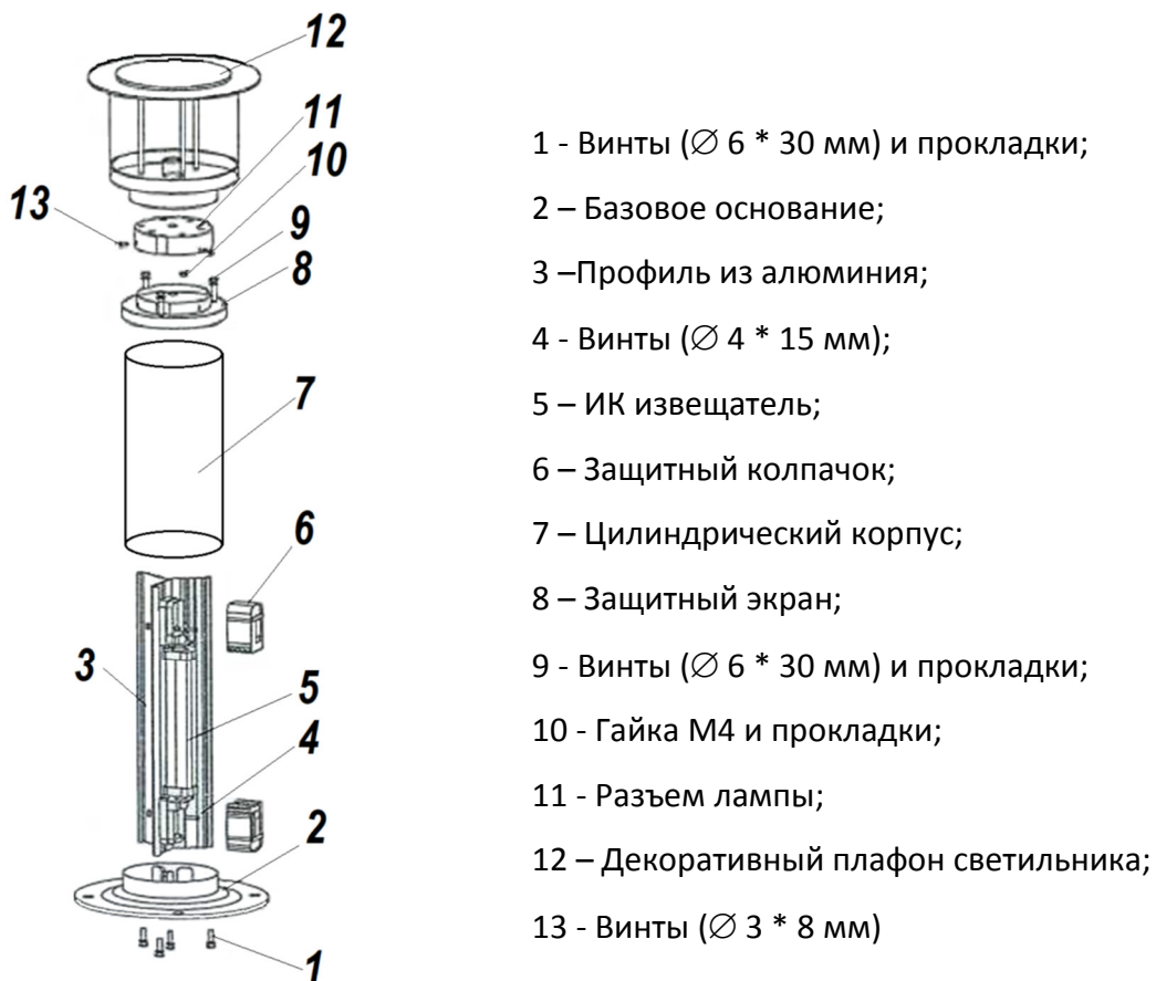
Рисунок 2.3 - Общий вид блока извещателя в декоративной башне
